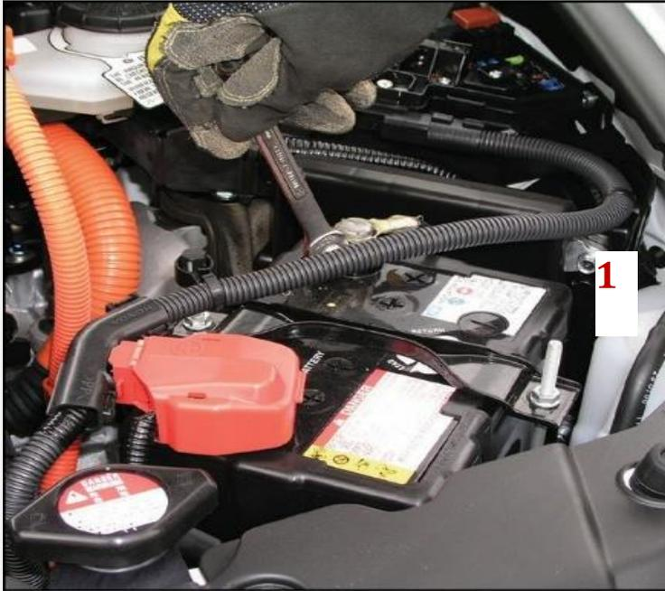
**PASO 1:** Desconecte la batería de 12v.
