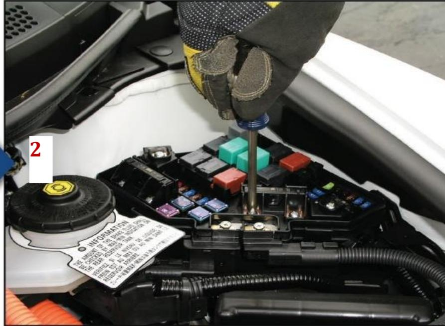
**PASO 2:** Extraiga los fusibles o relés de control del sistema HV. Esto será:
